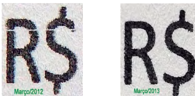
Figuras N° 2 y 3. Diferencias (chorros de tinta) en la estructura y densidad de los caracteres, así como en los bordes o "aristas", además del defecto (línea blanca) no observado en las versiones de la impresora utilizada en marzo de 2013.
