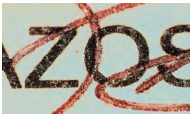
Figura N° 14. Fotografía a 40x donde se observa la continuidad del brillo rojizo de la tinta oleosa del bolígrafo, lo que indica que se encuentra por encima del impreso. Fuente propia.
