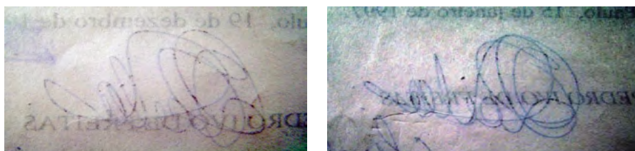
Figura N° 67. Firmas de dos copias originales que demuestran la retroproyección, es decir, la impregnación de las partículas de tóner de las impresiones en la primera hoja de otra copia, firmadas una sobre la otra.
