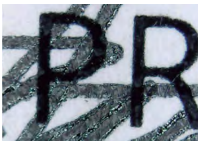
Figura N° 19. Fotografías a 40x donde se observa que el brillo de la tinta gel del bolígrafo se interrumpe al llegar al impreso, lo que indica que se encuentra por debajo del impreso. Fuente propia.
