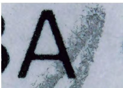
Figura N° 21. Fotografías a 40x en la que se observa que el brillo del lápiz se interrumpe al llegar al impreso, lo que indica que se encuentra por debajo del impreso. Fuente propia.
