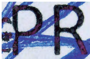
Figura N° 18. Fotografía a 40x donde se observa que el trazo de la tinta gel del bolígrafo al llegar al impreso se torna rojizo, lo que indica que se encuentra por encima del impreso. Fuente propia.
