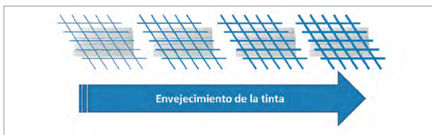
Figura N° 4. Representación gráfica del efecto de la polimerización de las resinas que componen las tintas con el paso del tiempo. Fuente propia.
