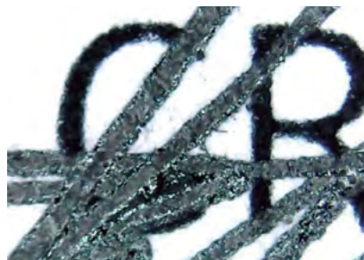
Figura N° 20. Fotografías a 40x donde se observa que el brillo de la tinta gel del bolígrafo no se interrumpe al llegar al impreso, lo que indica que se encuentra por arriba del impreso. Fuente propia.
