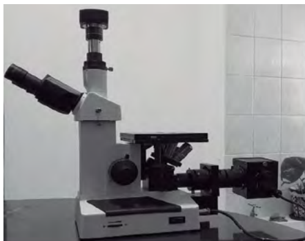
Figura N° 23. Microscopio metalográfico invertido con magnificaciones de 50x a 600x. Fuente propia.
