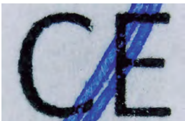
Figura N° 17. Fotografía a 40x donde se observa que el trazo de la tinta gel del bolígrafo se interrumpe al llegar al impreso, lo que indica que se encuentra por debajo del impreso. Fuente propia.
