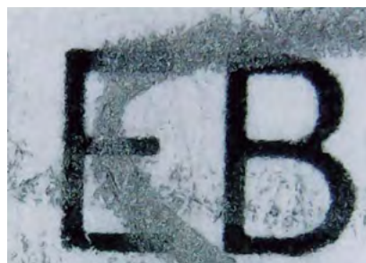
Figura N° 22. Fotografías a 40x en la que se observa que el brillo del trazo del lápiz al llegar al impreso continúa, lo que indica que se encuentra por encima del impreso. Fuente propia.
