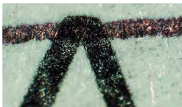
Figura N° 16. Fotografías a 200x donde se observa que el brillo rojizo de la tinta oleosa del bolígrafo se corta al hacer contacto con el impreso, lo que indica que se encuentra por debajo del impreso. Fuente propia.
