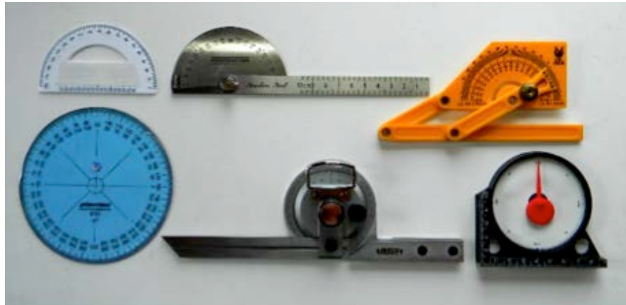
Imagen N° 5. Figura que ilustra: Transportador o graduador, Capserrat, Goniómetro simple o de ½ círculo, y Universal o circular, Protractor, Inclinómetro o clinómetro. (Imagen del autor).
