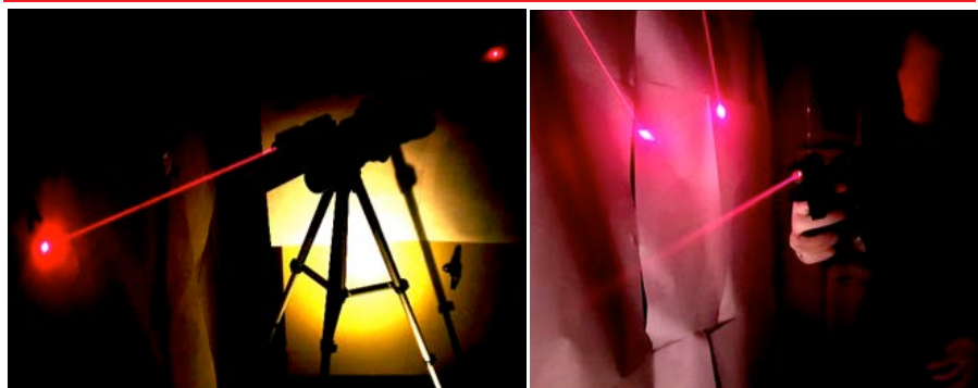
Imagen N° 9. Figura que ilustra dispositivos láser para determinación de trayectoria. (Imagen del autor).
