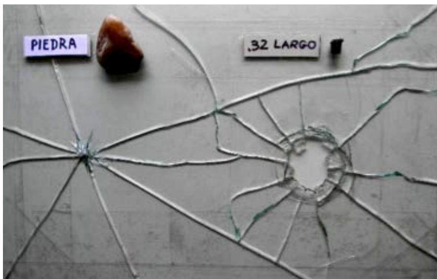
Imagen N° 1. Figura que ilustra a la izquierda el impacto de una piedra lanzada por impulso del brazo y a la derecha el impacto de un proyectil calibre .32 Largo. (Imagen del autor).
