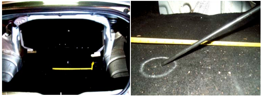
Imagen N° 3. Figura que ilustra el uso de sondas o varillas para reproducir trayectorias de proyectiles disparados por armas de fuego en el piso del baúl de un automóvil (Imagen del autor).
