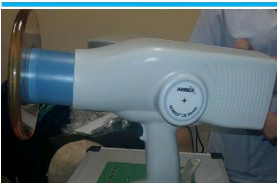
Figura 4. Equipo radiográfico dental portátil NomadTM. Fuente: el autor
