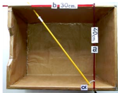
Imagen N° 4. Figura que ilustra procedimiento para determinar valor del ángulo correspondiente a la trayectoria de un proyectil disparado por un arma de fuego. (Imagen del autor).
